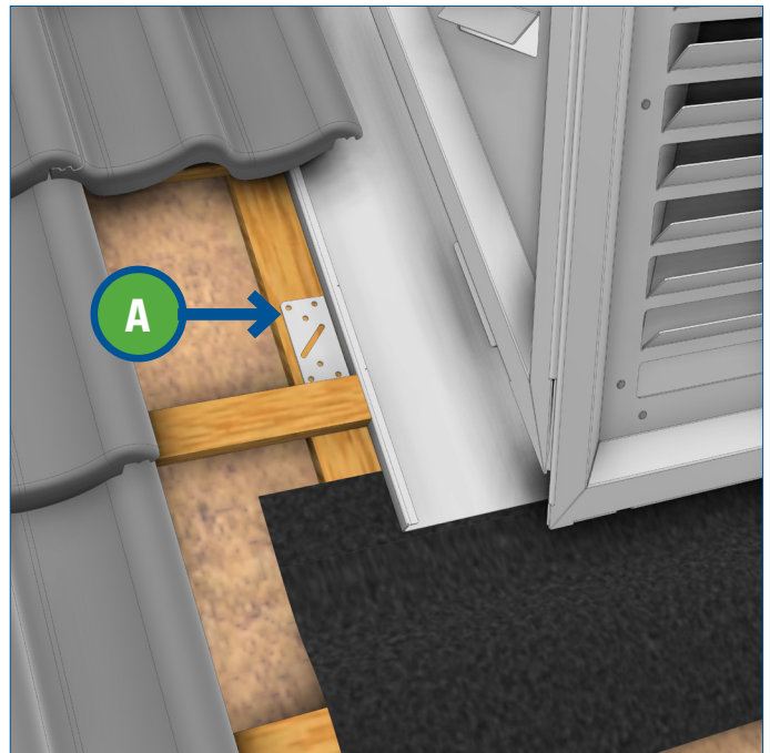
Figuur 3: Montagedetail spijkerstrip
